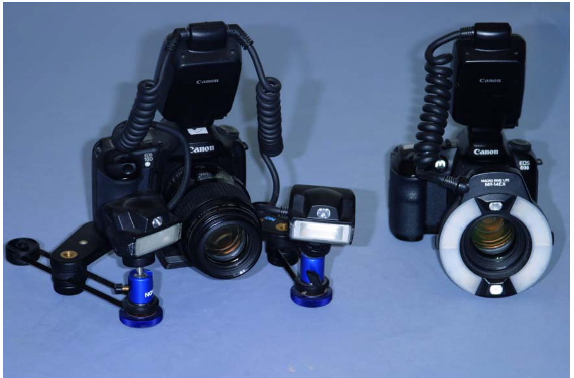
Abb. 1 Die Canon 10D (links) verwenden wir heute neben der Canon D30 (rechts). Lateralblitze sind gegenüber Ringblitzen im Vorteil, denn sie sorgen für einen stärkeren 3D-Effekt. Für Extra- oder Intraoralaufnahmen werden die Blitze, wie im Bild zu sehen, dicht an das Objektiv angeklappt. Der Ringblitz ist kein echter Kreis, sondern in zwei halbkreisförmige Einzelblitze unterteilt. Sie lassen sich mit der integrierten Ratio-Einstellung individuell steuern. Dadurch bekommen die Bilder einen etwas plastischeren Effekt und eine optimale Ausleuchtung ist jederzeit gesichert. Die Kamera der Wahl ist zurzeit eine Canon 20D. Manchmal bietet noch kein Hersteller eine wirklich funktionierende TTL Steuerung für die digitale Makrofotografie an.
